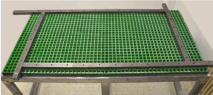
Figura 3.15: Marco usado con la placa CFRP2. Elaborado en el Grupo de Investigación.
