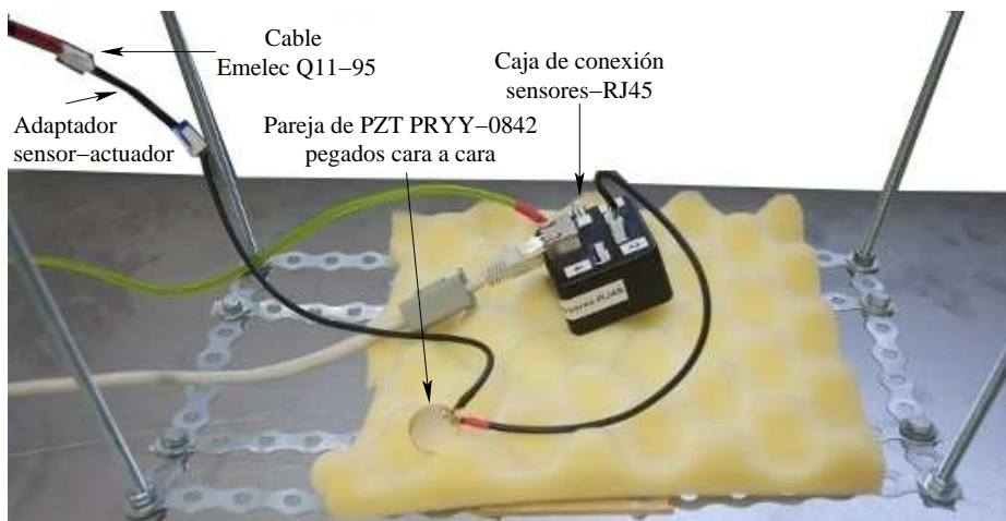
Figura 3.23: Pareja de PZT PRYY-0842 conectados al sistema completo de medida.
