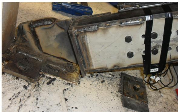
Figura 8.4: *Detalle de la fijación del disipador WPD a la chapa de sujeción entre los nudos viga-pilar de la estructura principal del edificio*
