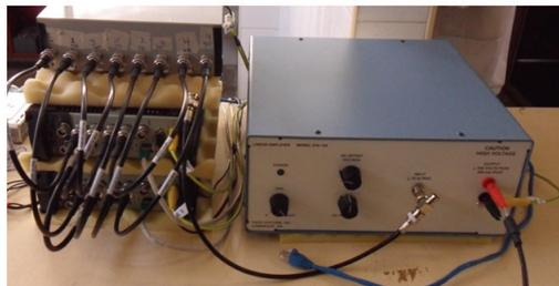
(c) Amplificador EPA104 y el sistema PULSE
