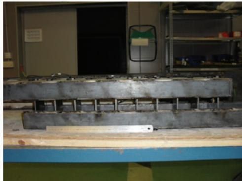
(c) *Vista lateral del disipador ensamblado*
