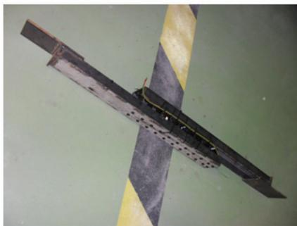
(a) *Disipador para la planta inferior*
