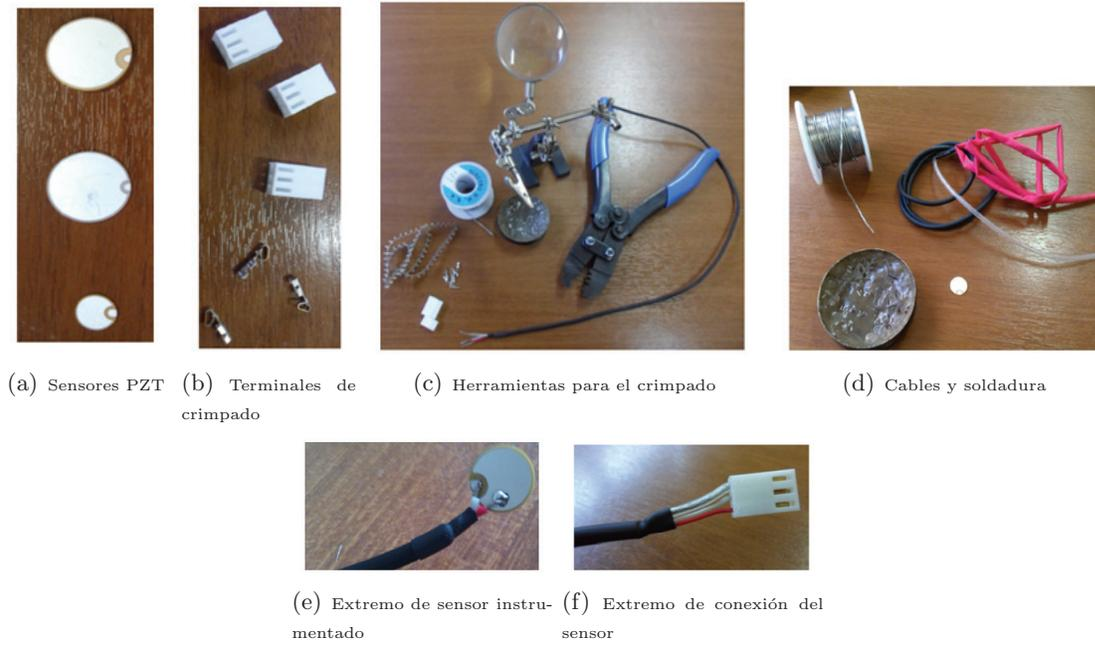
Figura 4.32: Instrumentación de un sensor PZT
