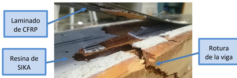
Figura 60. Delaminación del CFRP de la viga LRS2.
