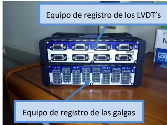
Figura 43. Equipo de registro de las galgas extensiométricas y LVDT's.
