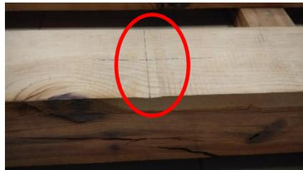
Figura 62. Hincado del pistón semicircular de la máquina de ensayos en la madera de la viga LRS2.
