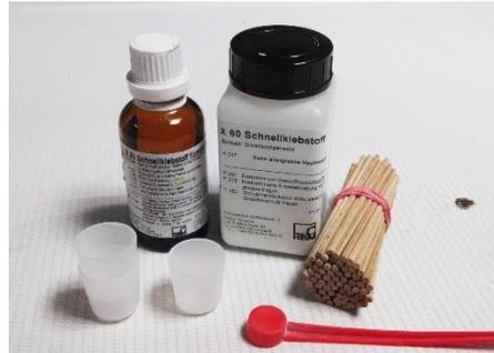
Figura 45. Componentes del adhesivo de fijación de las galgas extensiométricas.
