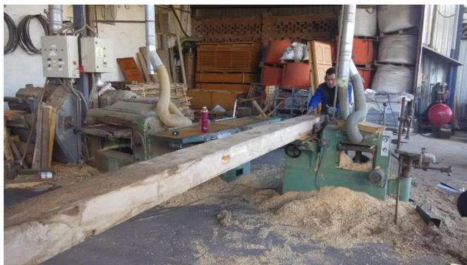
Figura 20. Cepillado de la viga para su regularización.
