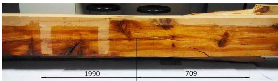
Figura 59. Rotura en la cara C de la viga LRS2. Cotas en mm.
