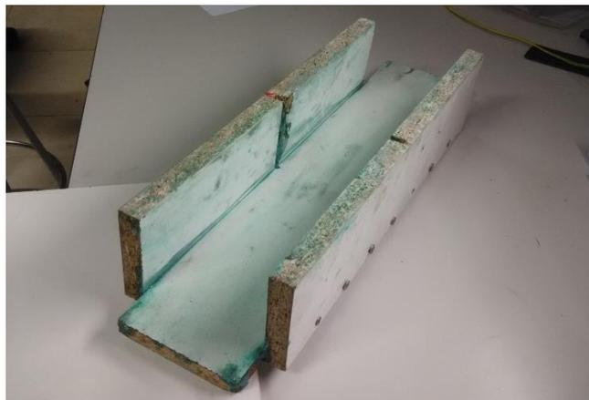
Figura 23. Dosificador de resina para el laminado.
