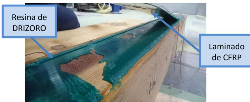
Figura 67. Delaminación del CFRP de la resina en la viga LRD1. Cotas en mm.
