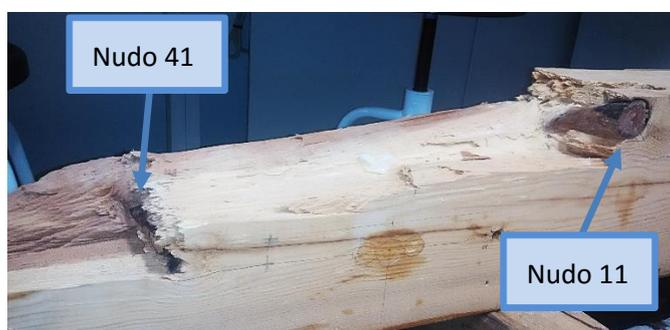
Figura 56. Nudos 11 y 41 de la viga LRS1 después del ensayo.
