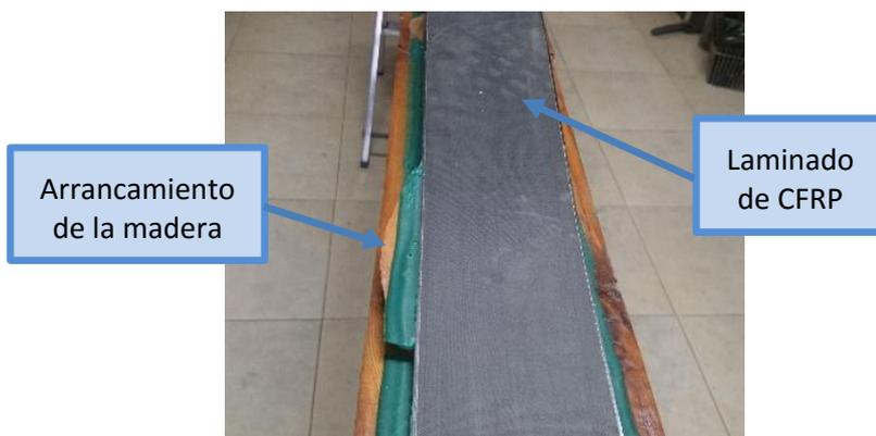
Figura 70. Delaminación del CFRP de la viga LRD2.
