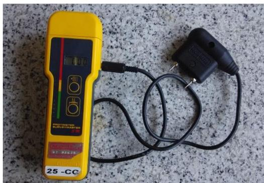
Figura 11. Higrómetro de resistencia eléctrica y sonda
