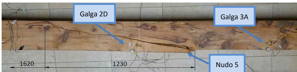
Figura 49. Rotura en la cara C de la viga SR1. Cotas en mm.
