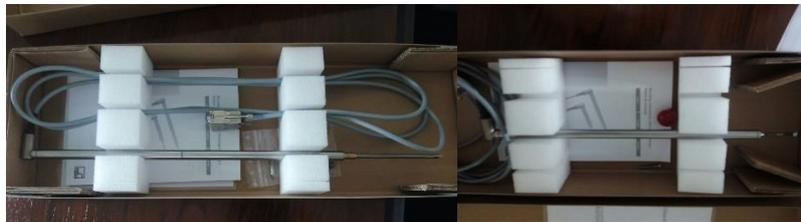
Figura 32. LVDT's empleados en los ensayos a flexión. Izq.: LVDT de 100 mm. Dcha.: LVDT de 200 mm
