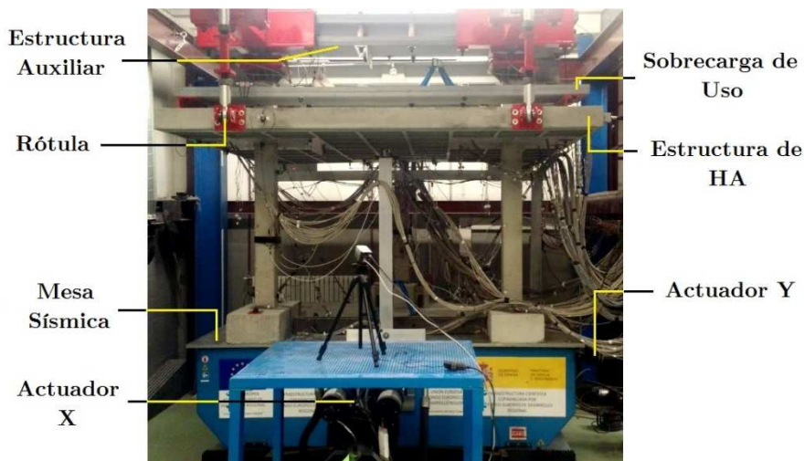
Figura 6.16. Configuración general del ensayo sísmico: Mesa sísmica de la Universidad de Granada (actuadores X e Y), estructura principal de HA con sobrecarga de uso, y estructura metálica auxiliar.
