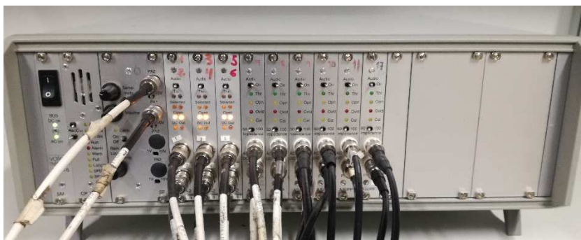
Figura 6.21. Equipo de adquisición AMSY-5 de señales de EA.
