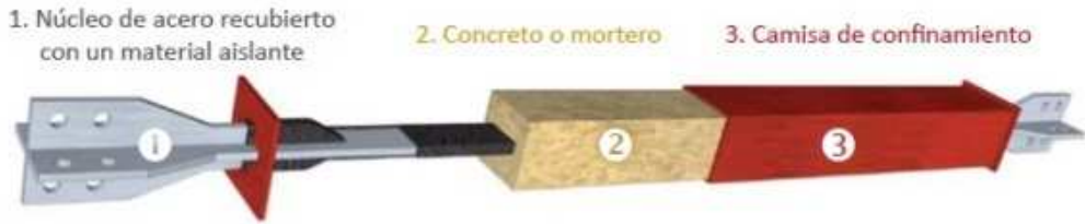
Figura 2.2. Esquema descriptivo del disipador BRB. Fuente: [59].
