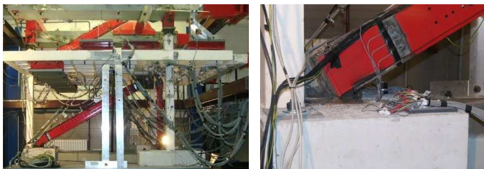
Figura 2.5. Disipadores tipo WPD. Izq.: Instalación del disipador en una estructura. Der.: Anclaje del disipador al nudo inferior.
