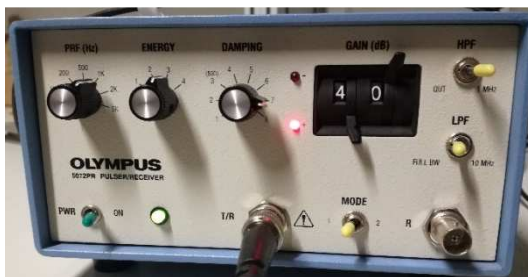
Figura 4.9. Generador de pulsos OLYMPUS 5072PR.
