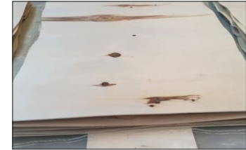
CHAPA DE BAJA CALIDAD USADA PARA LOS PANELES Q2
