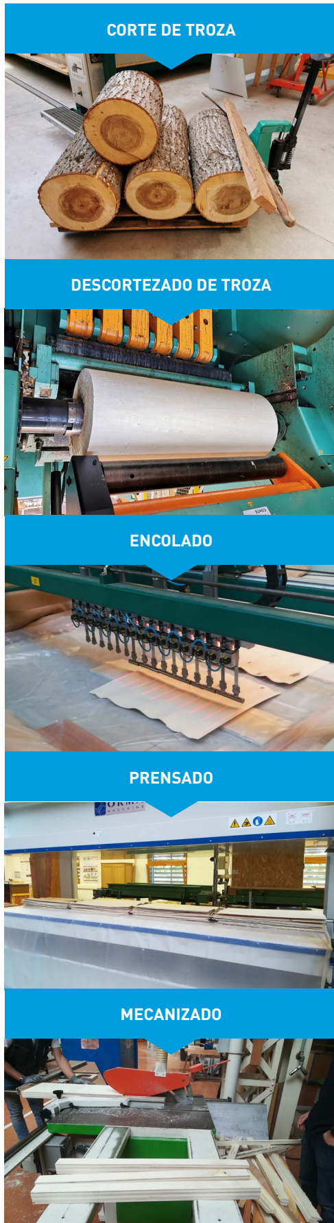
Figura 3: Elaboración de LVL de chopo para este trabajo.
