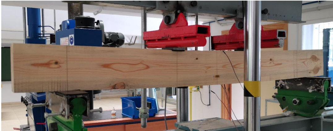
Figura 5. Imagen de ensayo de flexión
