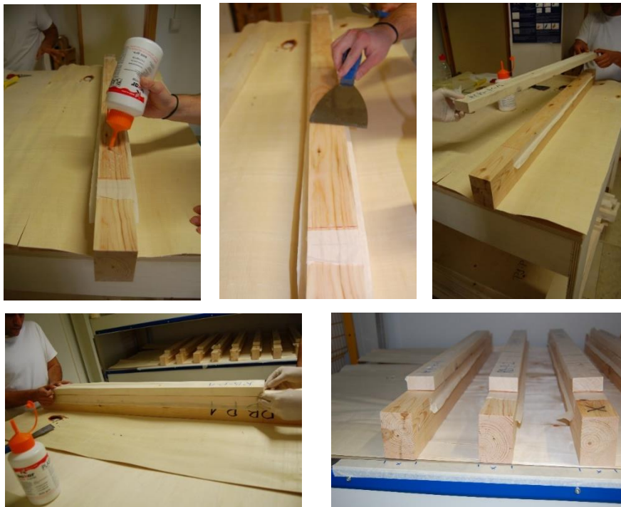
Figura 16. Imágenes del proceso de fabricación de las vigas (RB_P). Cotas en mm.
