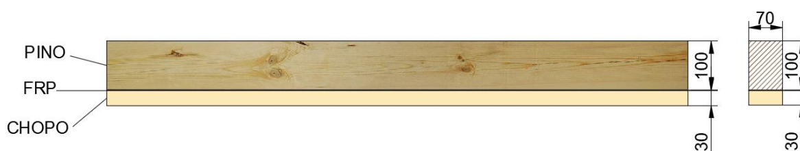
Figura 56. Detalle de viga reforzada RRB_S_FC
