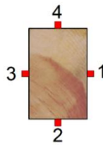
Figura 6. Esquema de la posición de las galgas en la sección central de la viga.
