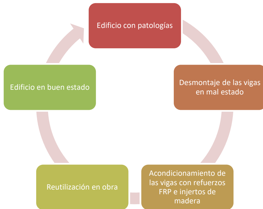
Figura 1. Diagrama de flujo. Propuesta de intervención en la reutilización de vigas.
