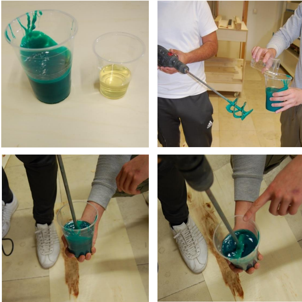
Figura 18. Imágenes del proceso de elaboración de la resina bicomponente.
