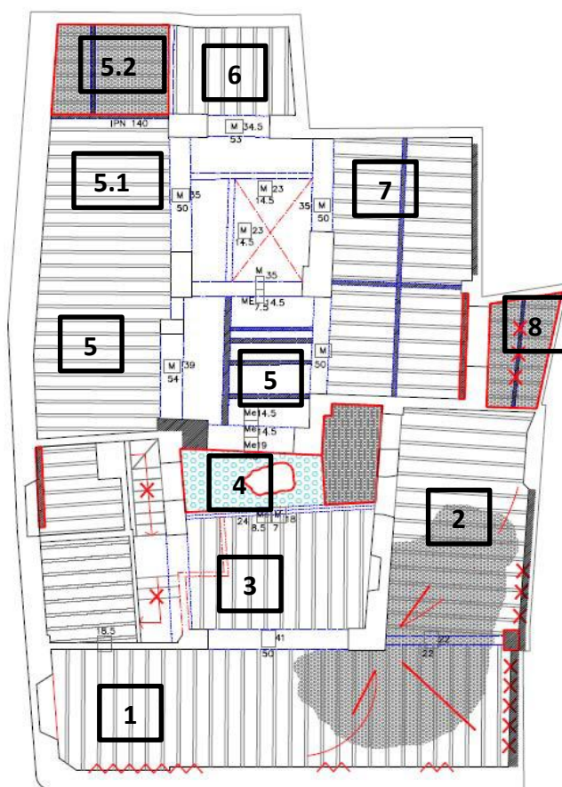
Figura 48. Plano de forjado de planta 1ª indicando las zonas de realización de la inspección visual.
